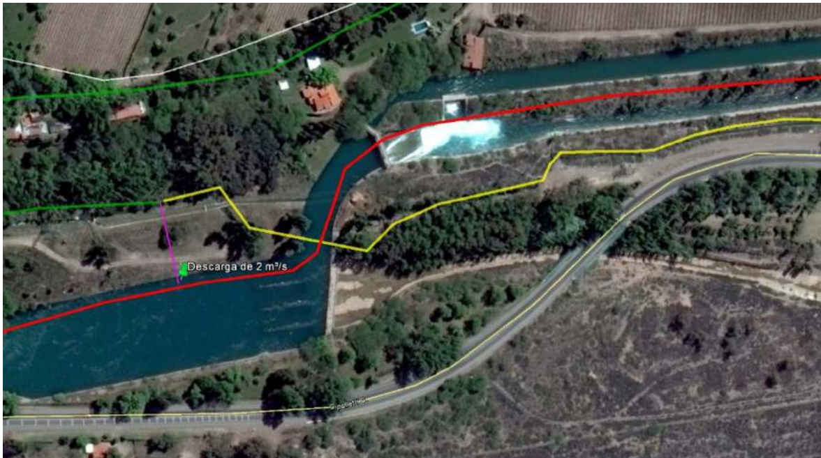
Figura N° 10. Nuevo descargador del Matriz Vistalba al Cipolletti – 2m 3 /s
