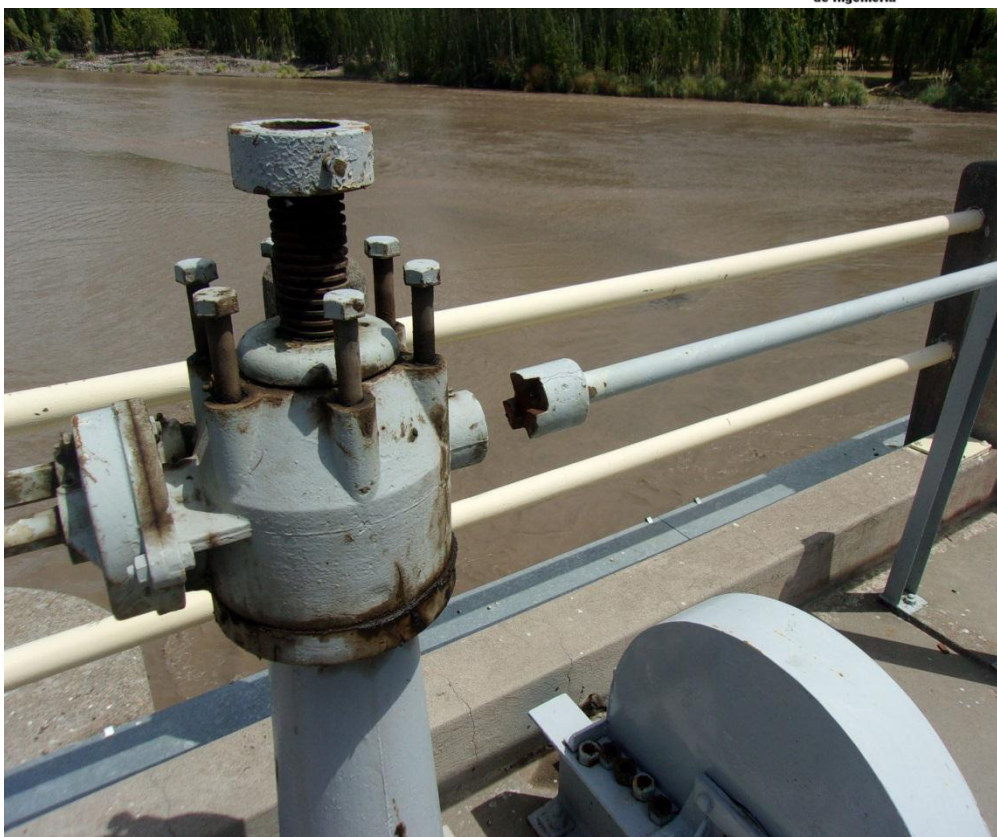
Árbol de transmisión desvinculado por fatiga en el ojal del chavetero.
