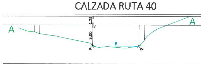
Figura 4 Croquis Relevamiento Topográfico - Arroyo Guiñazú
