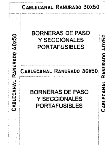
ESQUEMA DE DISTRIBUCIÓN DE ELEMENTOS EN BANDEJA TABLERO DE COMANDO Dimensiones Minimas de Bandeja ( 272mm x 385mm )
