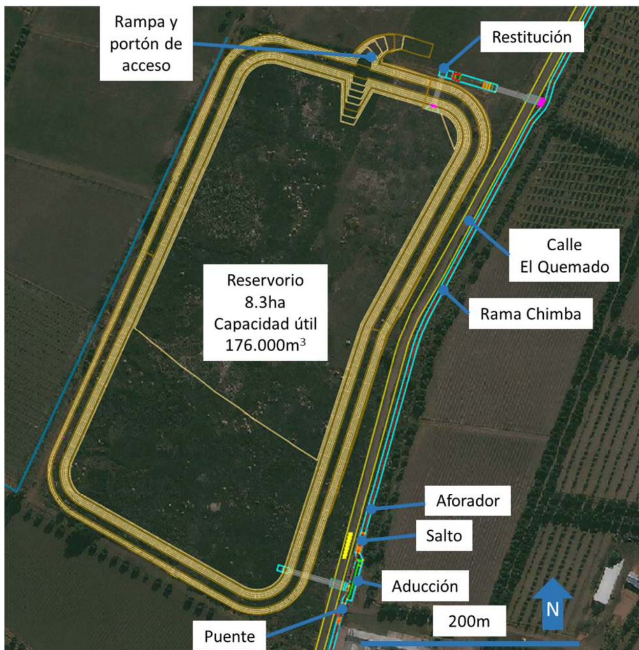
Figura Nº 27. Reservorio de regulación. Esquema de obras.
