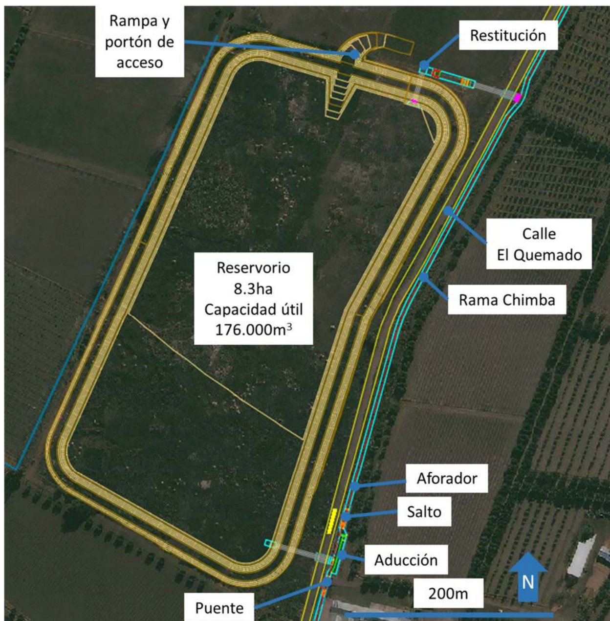
Figura Nº 27. Reservorio de regulación. Esquema de obras.
