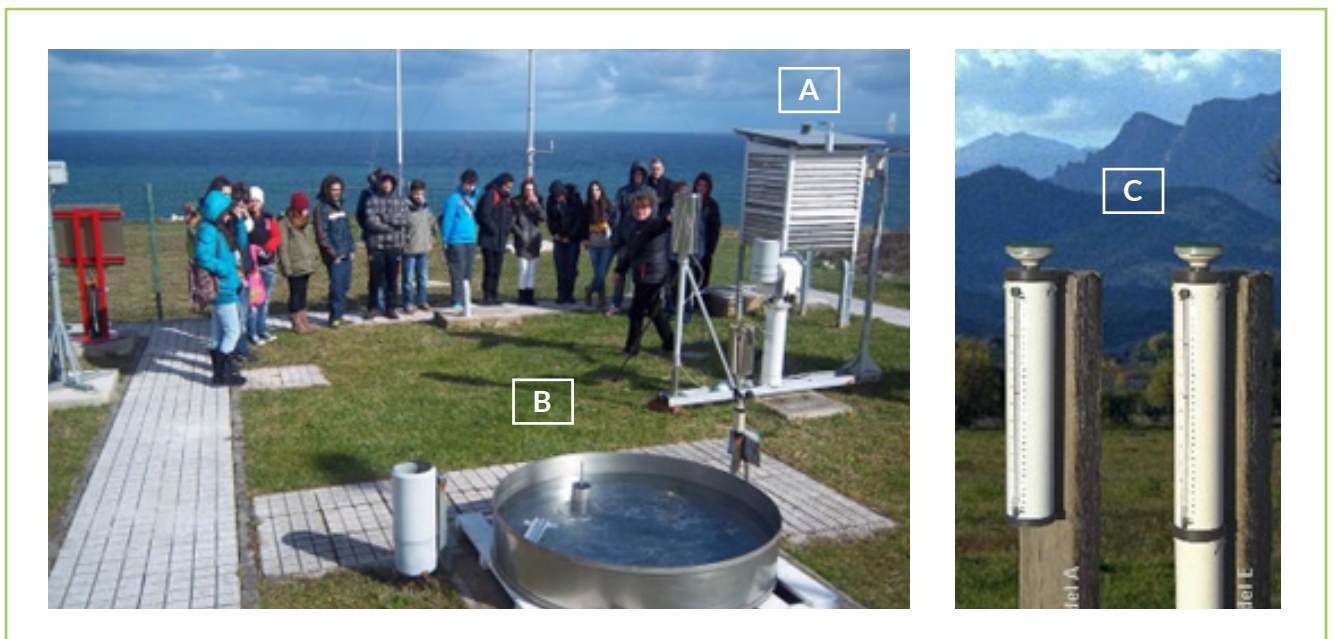
Figura 5: a) Estación meteorológica, b) Tanque Tipo A y c) Atmómetros.
