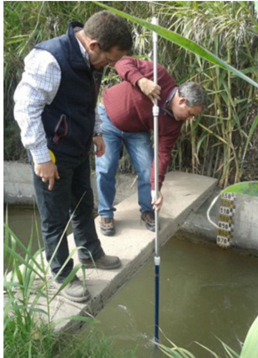
Figura 37: Aforo con moliente en canales
