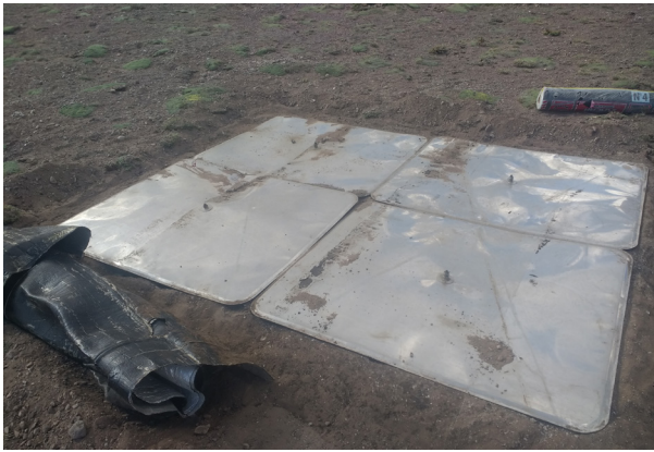
Figura 2. Snow Pillow antes de ser cubierto con membrana para protección.
