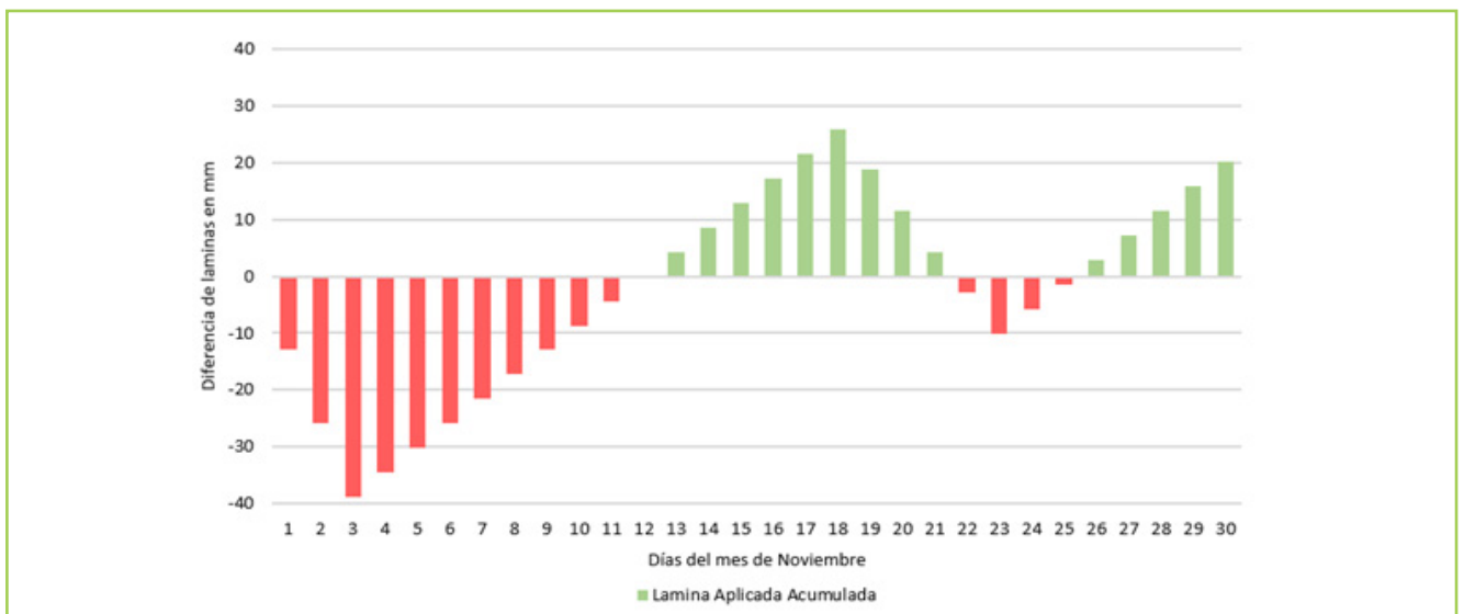
Diferencia entre lámina aplicada y lámina programada. Ejemplo práctico. Caudal solicitado de 400 l/s y 600 l/s
