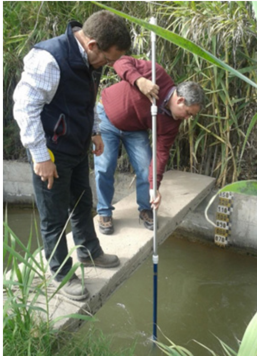
Figura 37: Aforo con moliente en canales
