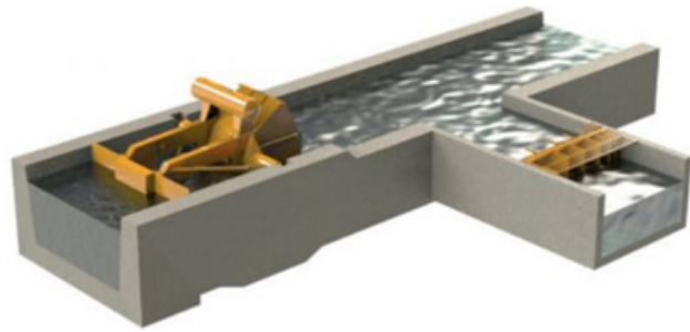
Figura 29: Toma en canal a la demanda de aguas abajo
