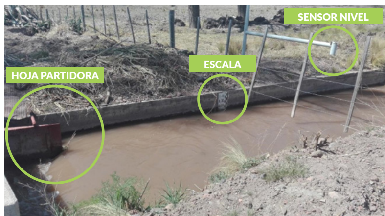
Figura 18: Partidor hijuela Villalobos y estación mido
