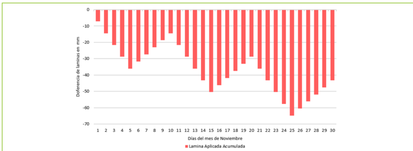
Figura 7: Diferencia entre lámina aplicada y lámina programada. Ejemplo práctico. Caudal solicitado de 400 l/s
