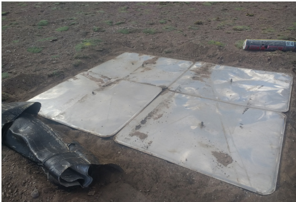
Figura 2. Snow Pillow antes de ser cubierto con membrana para protección.
