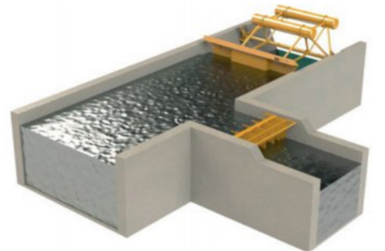
Figura 31: Toma en canal con poco dominio
