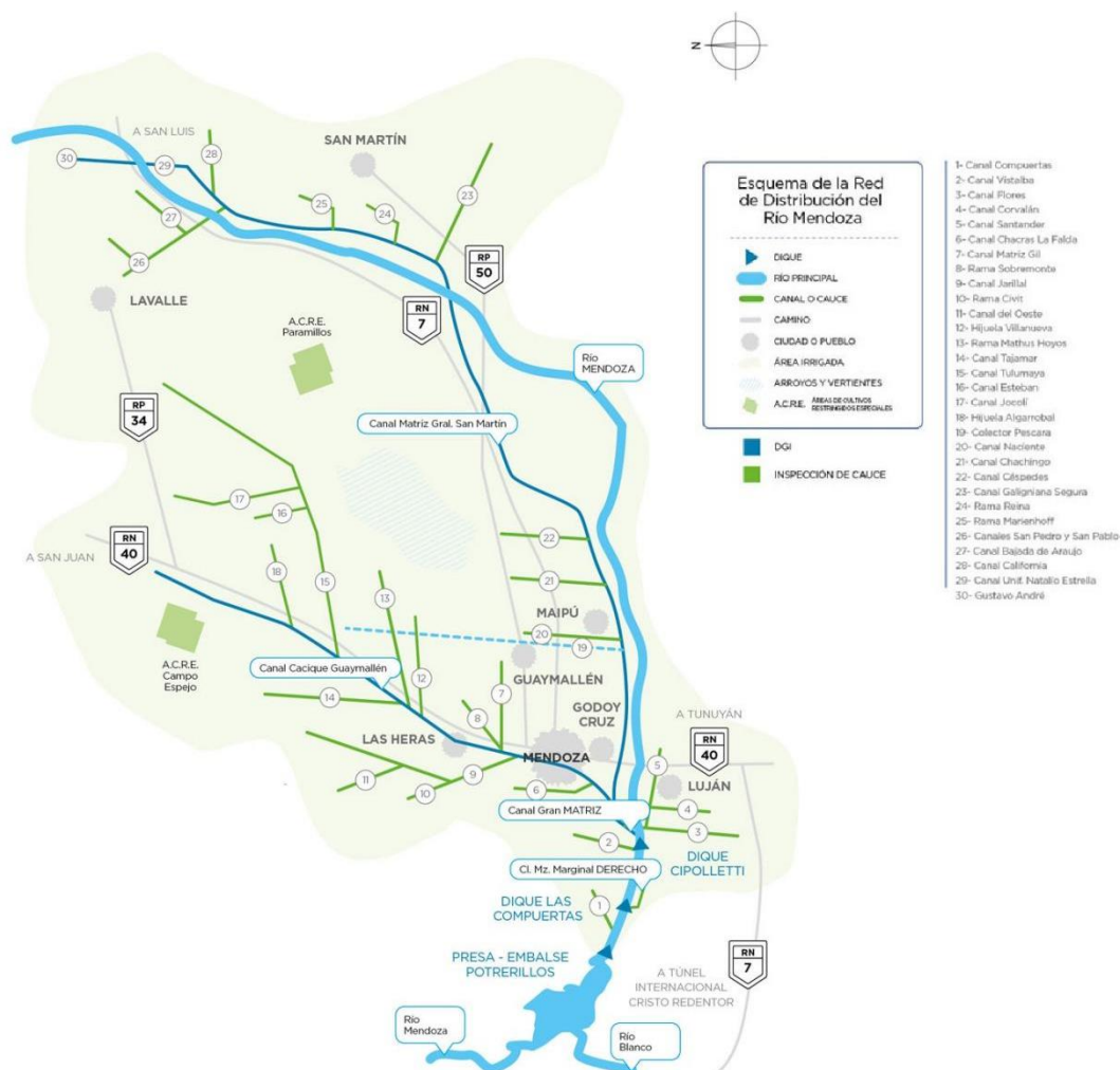
Ilustración 47 Esquema de la red de distribución de agua de riego – río Mendoza 63
